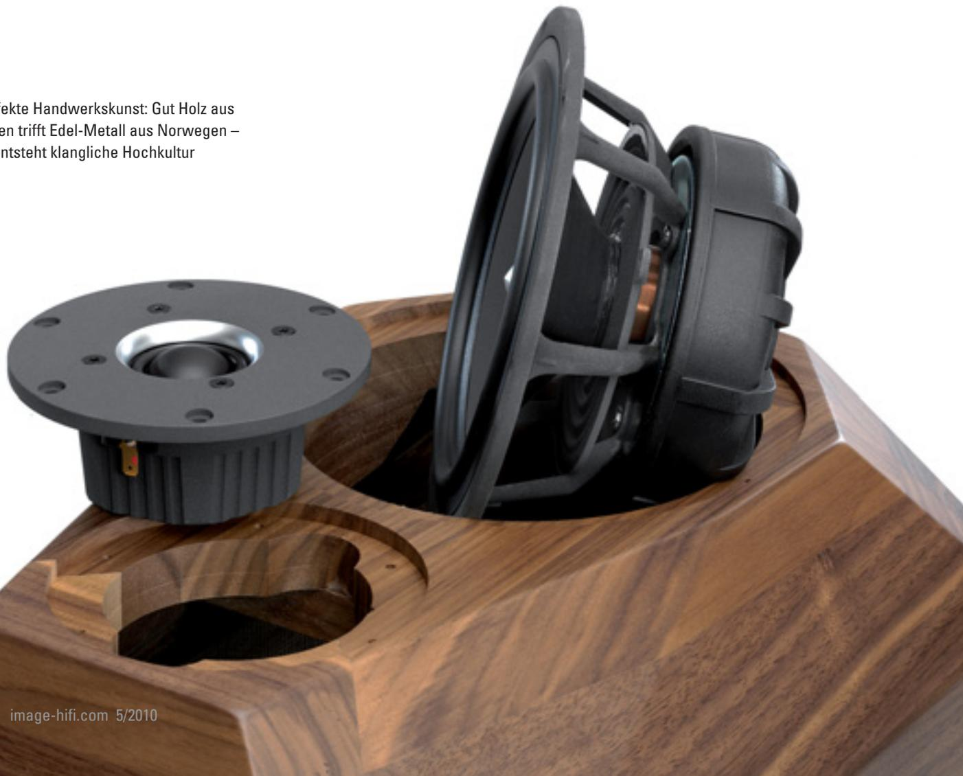
verwendet Diapason für den Ástera massives Walnussholz: um das Schwingungsverhalten noch weiter zu optimieren, sogar mit unterschiedlichen Wandstärken in den verschiedenen Gehäusebereichen. Ziel ist also, den Lautsprecherchassis ein akustisch möglichst neutrales Kabinett zur Verfügung zu stellen. Dazu tragen auch die durch die äußere Formgebung bedingten Wandschrägen im Innenraum bei, weil sich an nicht parallelen Flächen keine klangschädlichen Kastenresonanzen ausbilden können.
